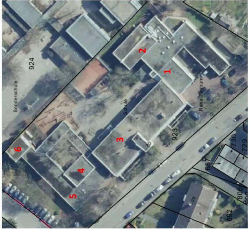
Die Dächer 1 und 3 werden nicht verschattet und bieten genug freie Fläche für die Anbringung einer PV-Anlage.
