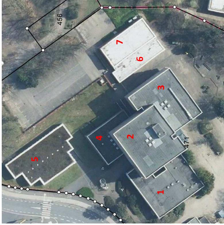
Die Dächer 2 und 3 sind für die Anbringung einer PV-Anlage gut geeignet, da sie nicht bis kaum verschattet werden und viel freie Fläche bieten. Da sie in einigen Jahren saniert werden, kann die Anbringung mit der Sanierung verbunden werden. Die anderen Dächer sind nicht für die Anbringung einer PV-Anlage geeignet.
