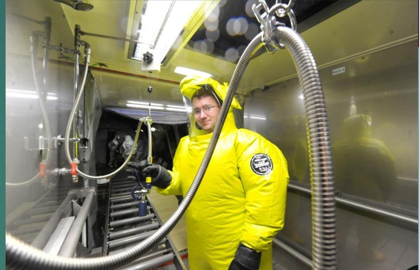
Auf zwei parallelen Rollbahnen werden die nicht gefährlichen Kontaminierten von Helfern in Chemikalienschutzanzügen durch den Dekon-Container geschoben und von Giftstoffen befreit.
