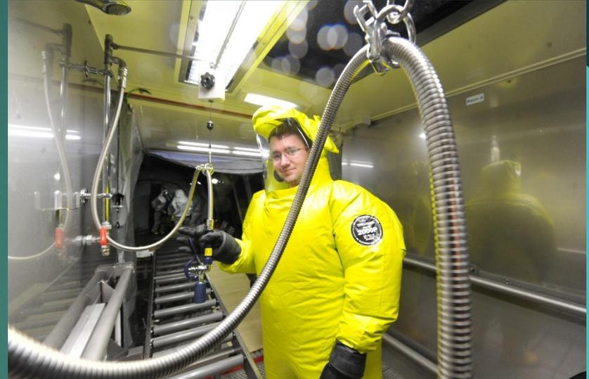
Auf zwei parallelen Rollbahnen werden die nicht gehfähigen Kontaminierten von Helfern in Chemikalienschutzanzügen durch den Dekon-Container geschoben und von Giftstoffen befreit.
