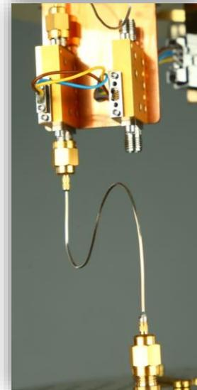
Kabel (z.T. supraleitend) und Transistoren
