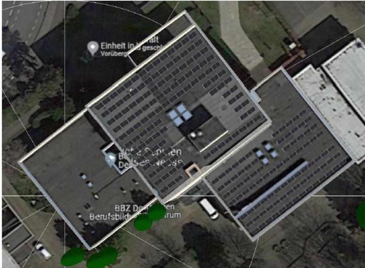
Die in der obigen Abbildung exemplarisch dargestellten Module auf Dach A und B haben einen Neigungswinkel von 30° und erzeugen zusammen pro Jahr ungefähr 78.500 kWh Strom. In zwei Simulationen wurde zusätzlich die vollständige bzw. teilweise Belegung mit Photovoltaik auf Dach C untersucht. In der untenstehenden Tabelle sind drei Varianten gegenübergestellt. Als wirtschaftlich und energetisch sinnvoll werden Simulation 1 und 5 empfohlen.
