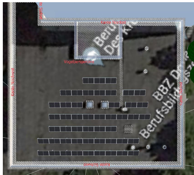
Abbildung 8: Mögliche Belegung der wenig verschatteten Fläche auf Dach C
