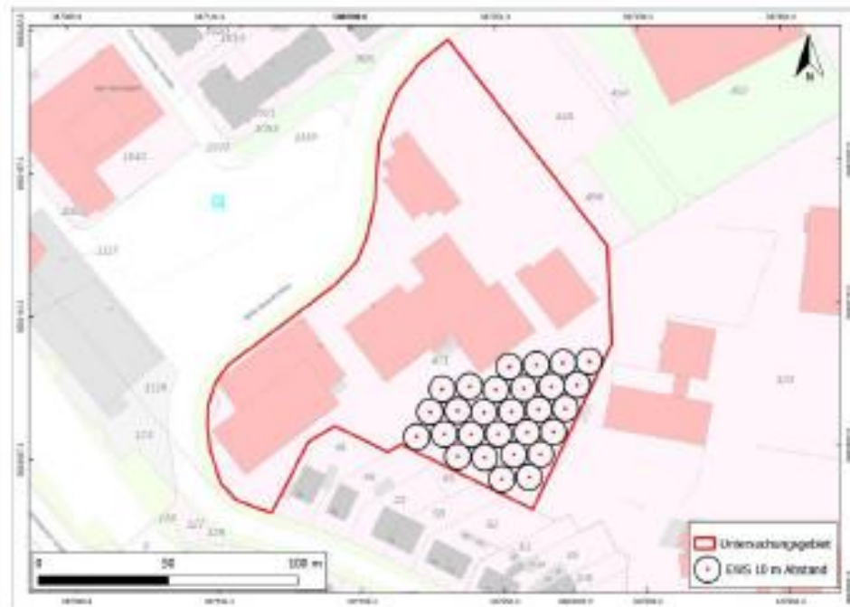
Mögliches Erdsondenfeld Variante 2
