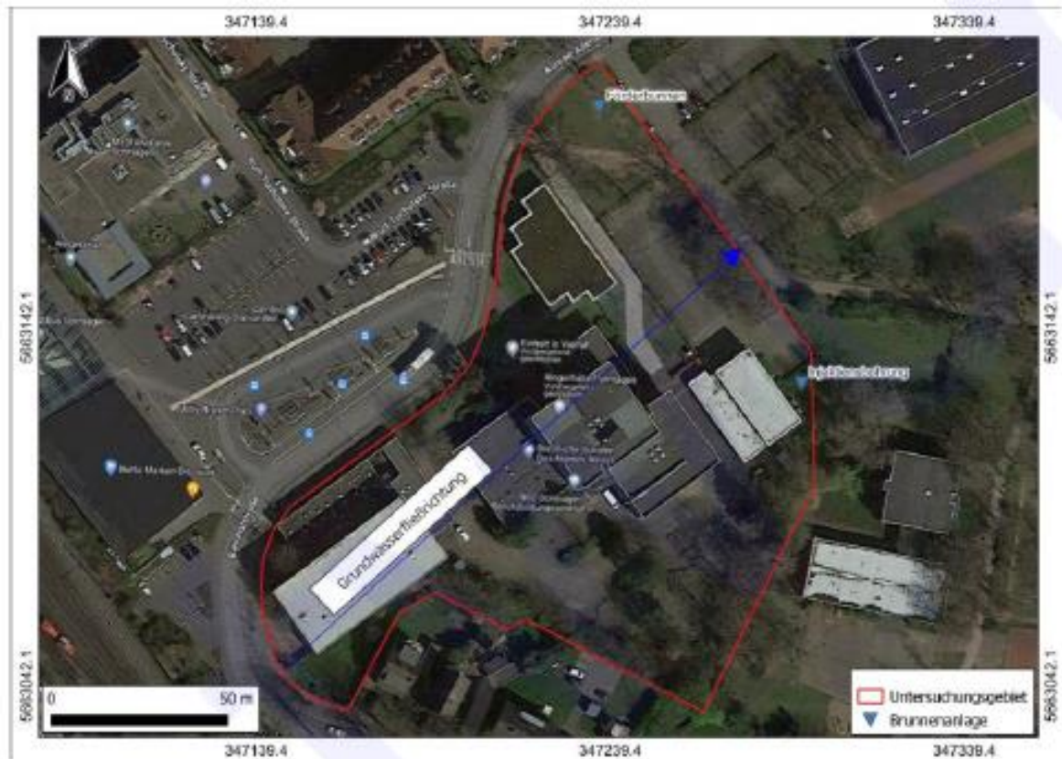
Mögliche Platzierung der geothermischen Brunnen auf dem Grundstück
