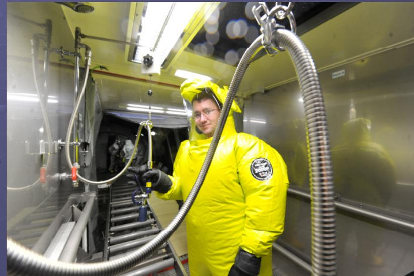
Auf zwei parallelen Rollbahnen werden die nicht gehfähigen Kontaminierten von Helfern in Chemikalienschutzanzügen durch den Dekon-Container geschoben und von Giftstoffen befreit.
