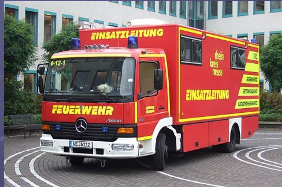
Das Fahrzeug ist mit 4 PC-Arbeitsplätzen, 2-m- und 4-m-Funk, unterschiedlichen Telefonnetzen, Telefax und eigener Stromversorgung ausgerüstet.
