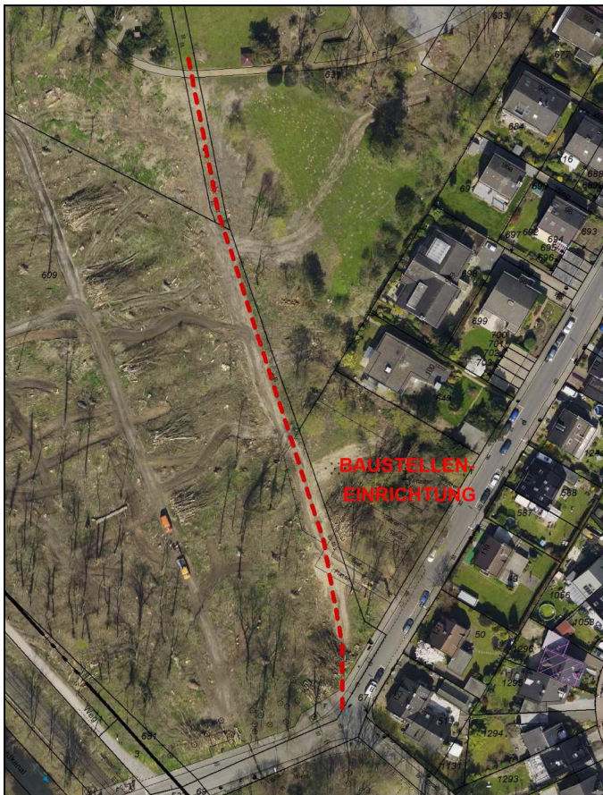
Verlauf Kanaltrasse alt / neu
