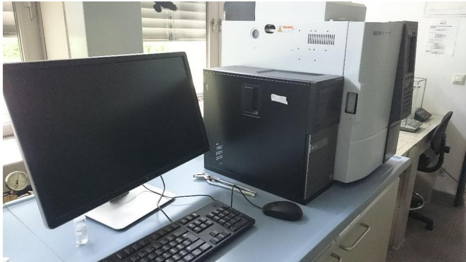
Abb. Rechner zur Steuerung des Gaschromatographen (nicht im Pädagogischen Netz integriert)
