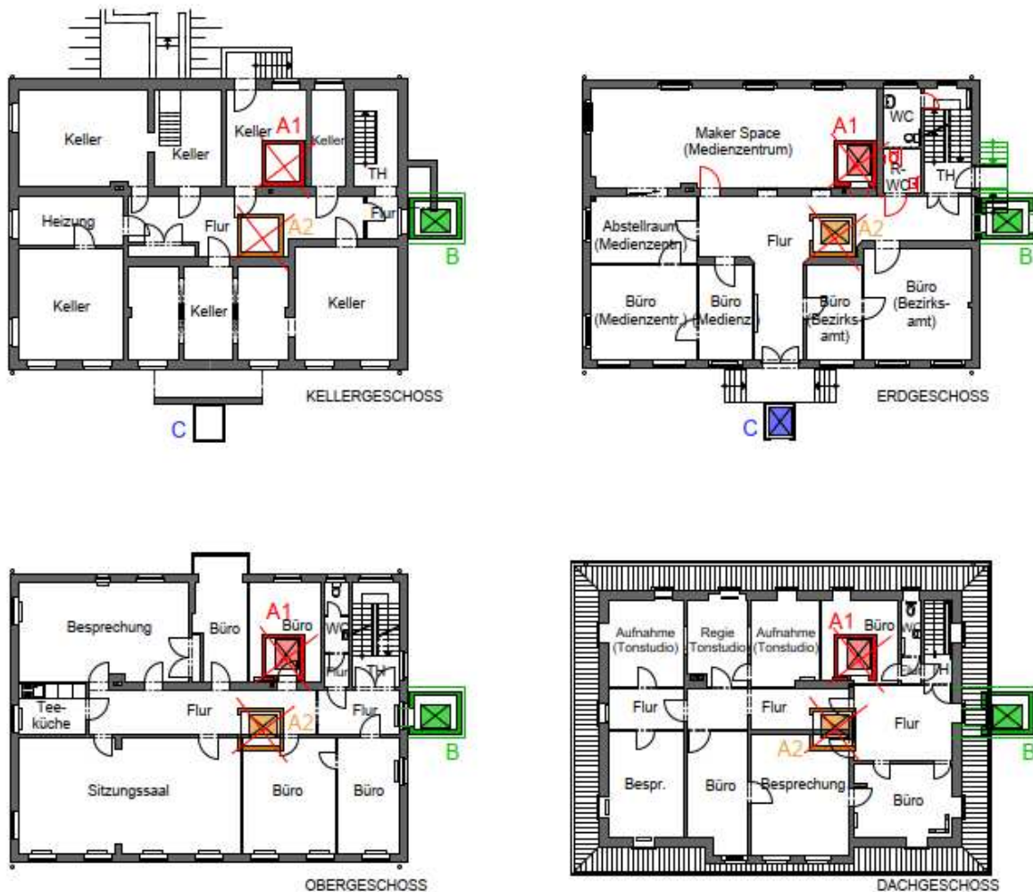
Grundrisse mit Standortvarianten Aufzüge / Hebeplattform
