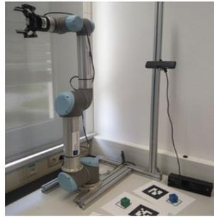
Ein Themenfeld der Industrie 4.0 ist die „kollaborative Robotik“, bei der Werker und Roboter miteinander interagieren. Leichtbauroboter werden für industrielle Anwendungen verwendet und mit entsprechender Sensorik ausgestattet, um intelligente und flexible Manipulationsaufgaben zu verrichten. In diesem Kurs werden wichtige Grundlagen der Roboterprogrammierung vermittelt, die am Ende des Kurses in
